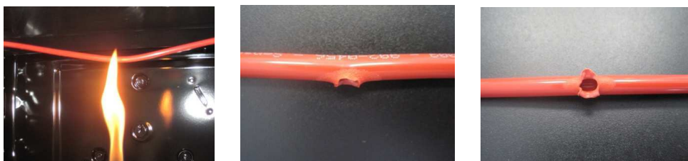
Εικόνα 1. Διάρρηξη σωληνακίου υπό την εκδήλωση φλόγας
