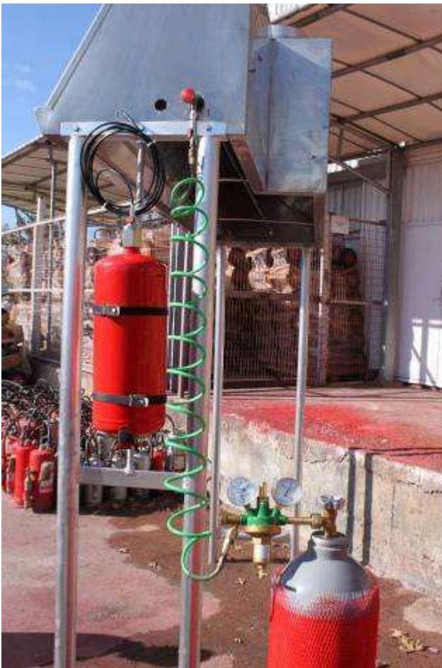
Εικόνα 6. Διαδικασία πλήρωσης του σωληνακίου ανίχνευσης θερμότητας με άζωτο πίεσης 2 bar (max. 20bar) επιπλέον από την πίεση λειτουργίας του πυροσβεστήρα., με τη βοήθεια του ειδικού αντάπτορα πλήρωσης
