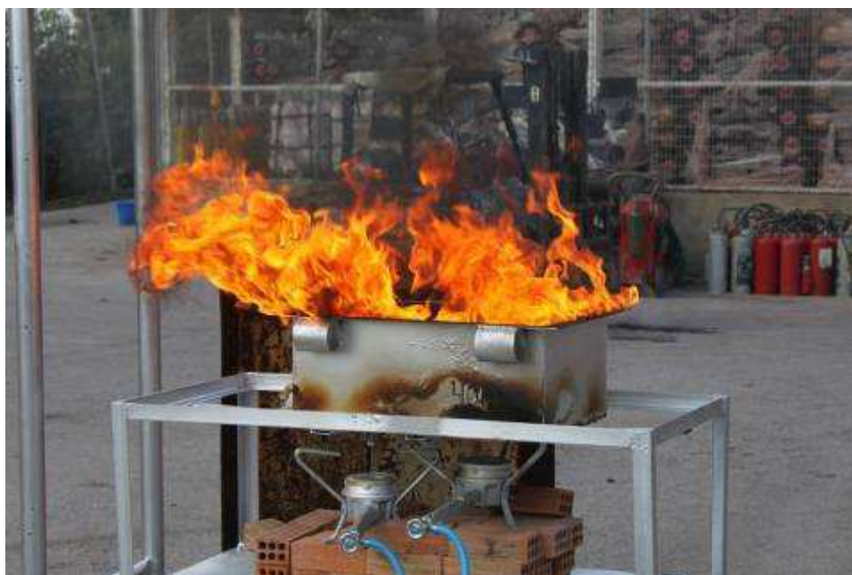
Εικόνα 8. Έναρξη αυτανάφλεξης λαδιού μέσα στο δοκίμιο («σχάρα») που χρησιμοποιήθηκε
