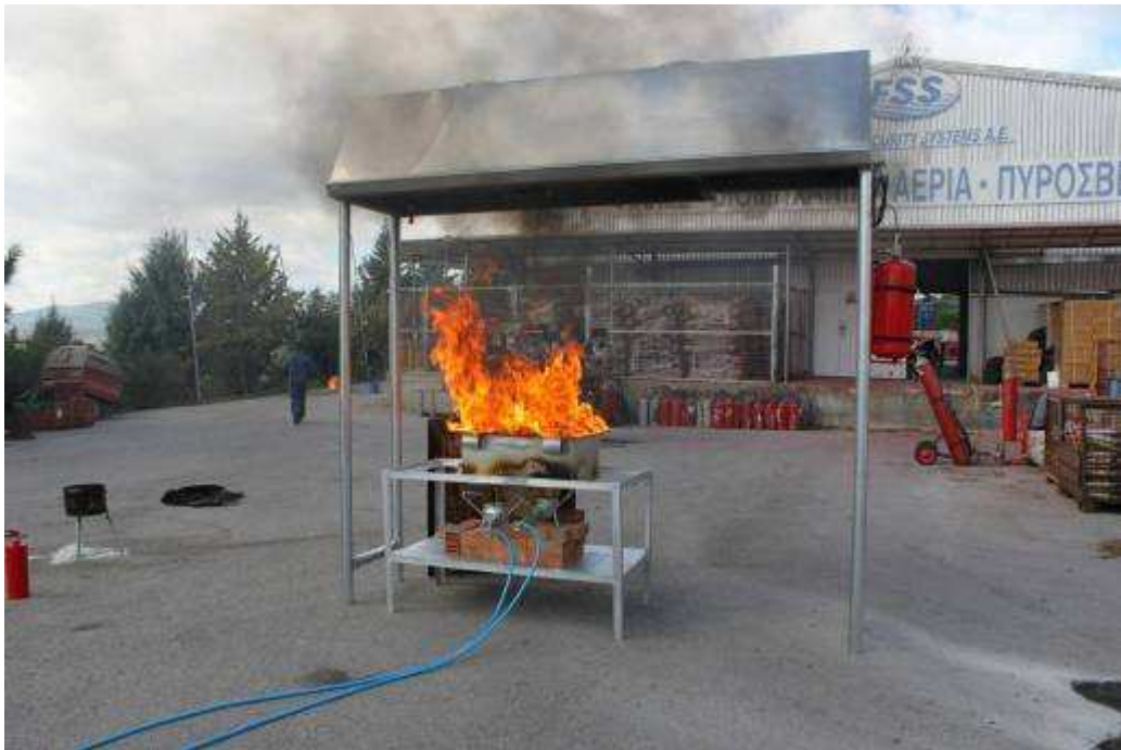
Εικόνα 9. Απεικόνιση της πλήρους εγκατάστασης του συστήματος κατά τη διάρκεια έναρξης καύσης του λαδιού
