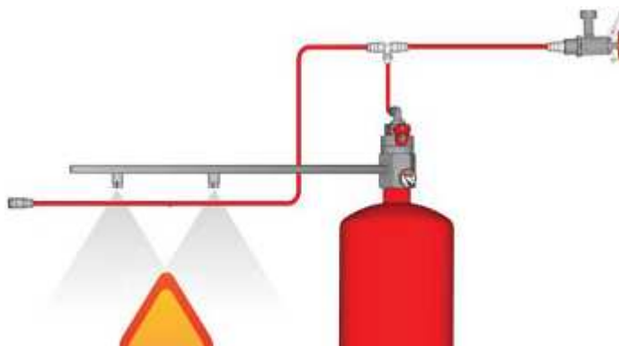
Εικόνα 2. Αρχή λειτουργίας συστημάτων έμμεσης ενεργοποίησης
