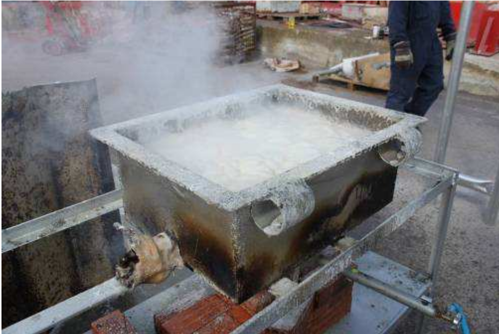
Εικόνα 11. Πλήρης «αφροποίηση» καίόμενου λαδιού μετά από την κατάσβεση
